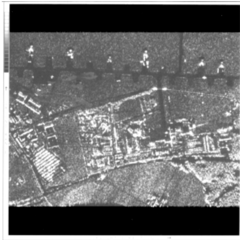
Abb. 3.15: Beispiel für eine gute Abbildungsqualität mit SAR bei einem C/N von 5 dB und weniger. Die Szene zeigt das DLR-Gelände (unten) mit dem Flughafen, aufgenommen im C-Band ( \lambda = 5 cm) aus einer Flughöhe von 914 m. Die Abmessungen der Szene sind 2700 \text{ m} \times 270 \text{ m} , prozessiert mit 8 Looks, (Quelle: DLR).
